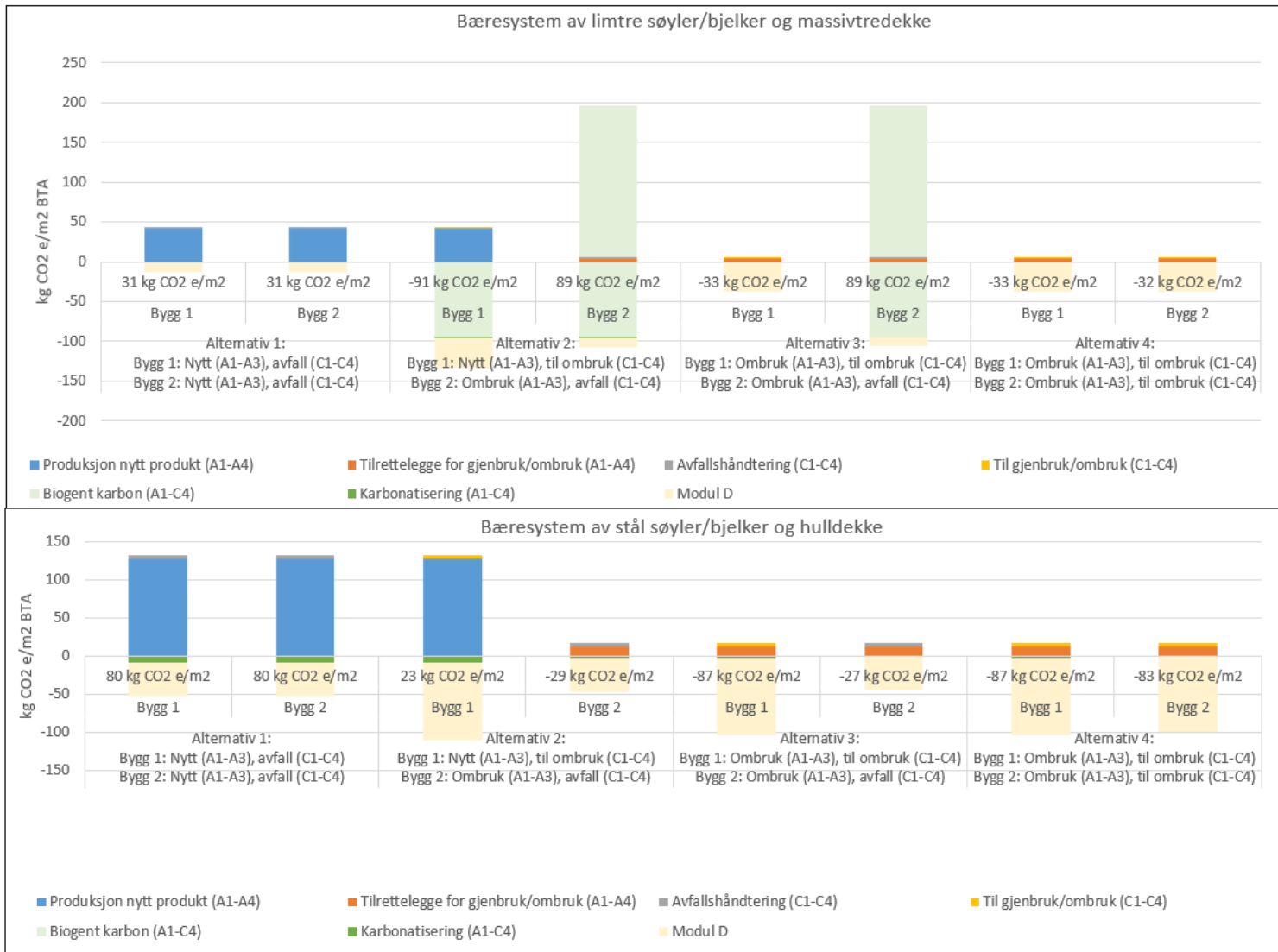
Figur 27: Resultat av metode 8b: kombinasjon av metode 1b og 3b med biogent: polluter pays, med modul D
