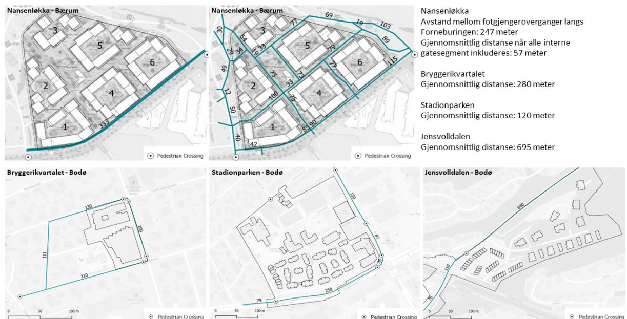
Figur 5.7 Gatekryssetetthet og gjennomsnittlig distanse mellom fotgjengeroverganger for områdene.
